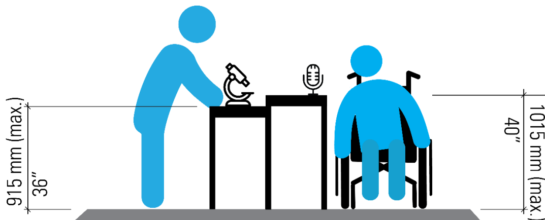
Figure 5.1.3c Hauteurs maximales pour microphone et microscope installés sur une table
